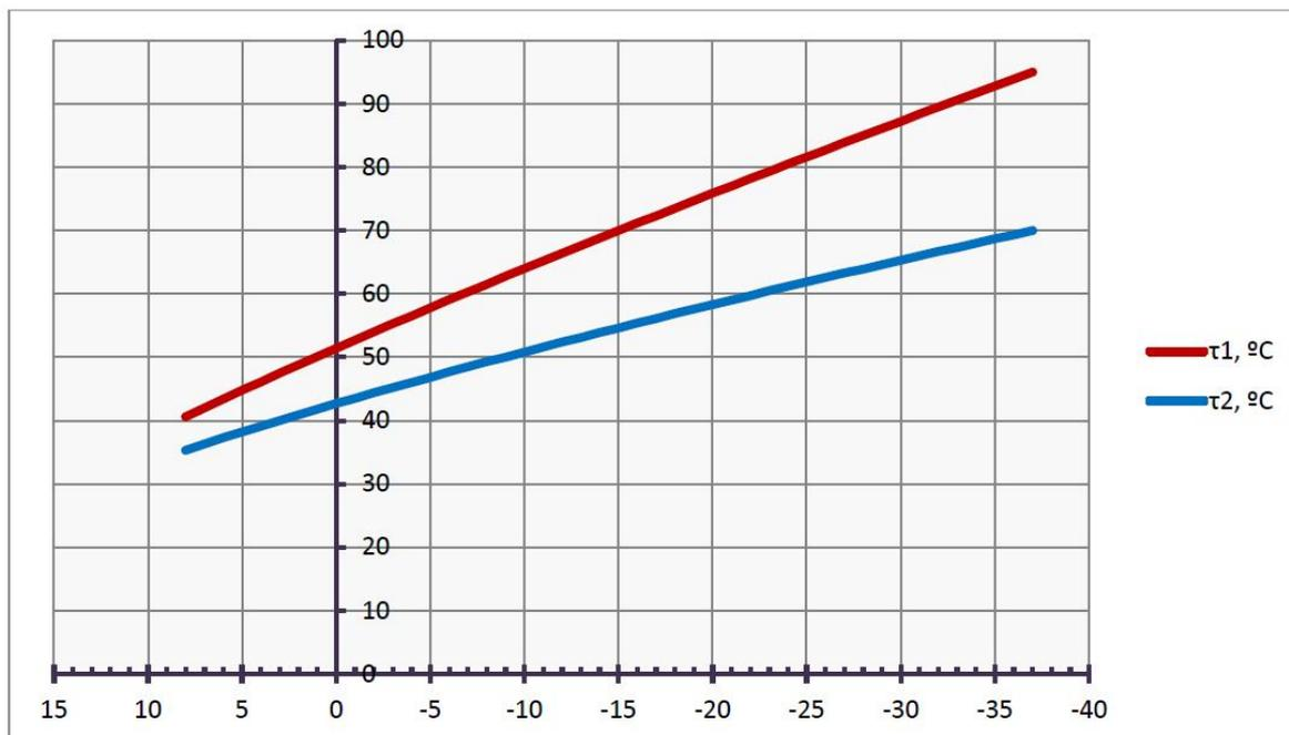
Рисунок 1 – Расчётный температурный график 95/70<sup>0</sup>С
