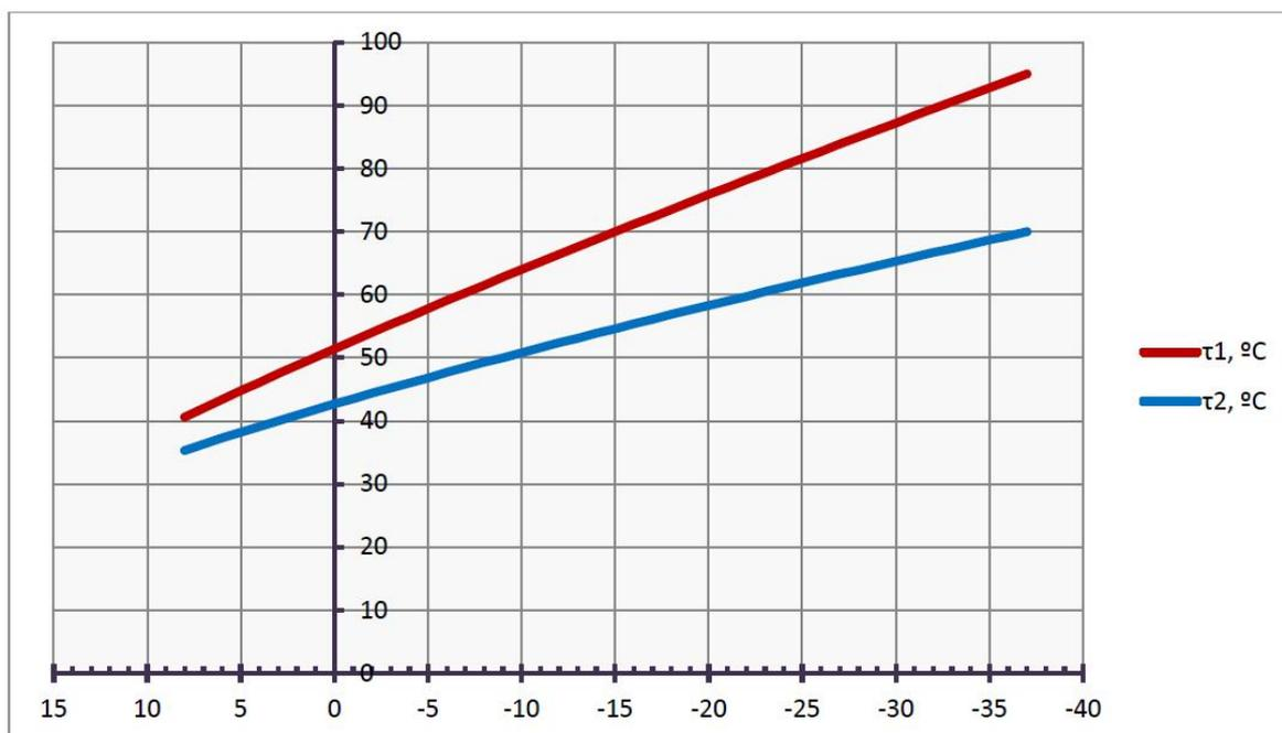
Рисунок 1 – Расчётный температурный график 95/70<sup>0</sup>С
